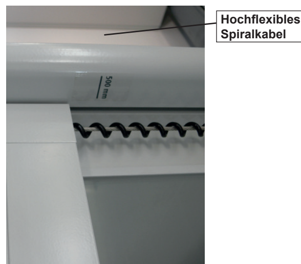
Lichtschranken-kabel (hochflexibles Spiralkabel) um Frontschieberseil
