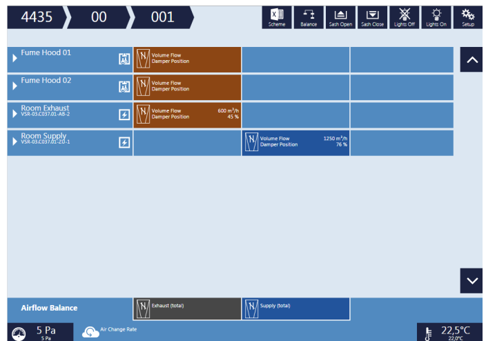
Bild 8: Touchscreen-Controller PAD7000 mit Visualisierung VIS7000, Etagedarstellung (links) und Raumdarstellung (rechts)
